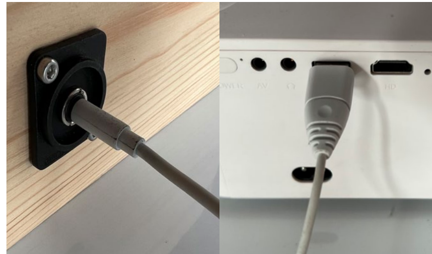
Debemos conectar el cable jack de los altavoces al conector lateral del Sonògraf, y el cable USB de los altavoces al videoprojector
